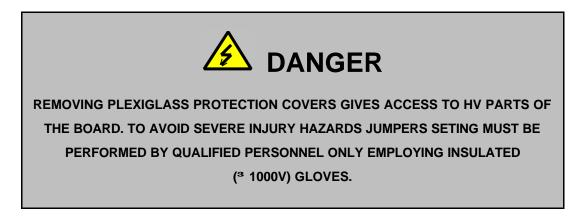
N.B.: IT IS STRONGLY RECOMMENDED TO PERFORM JUMPERS SETTING WHEN THE SY 527 SYSTEM IS TURNED OFF.
