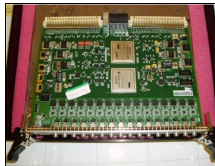
JLab 250MHz Flash ADC
